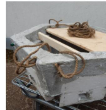
*Leichtbeton mit einer Dichte unter 1 schwimmt bereits als Material, wenn es noch Luft umschließt, trägt es trotz großem Eigengewicht.*
