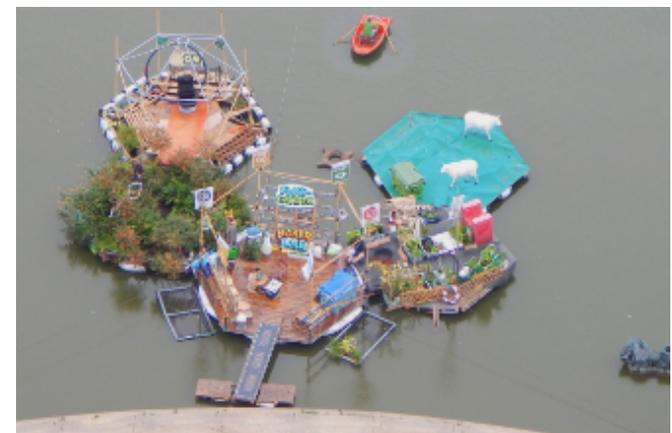
Open-Island aus 5 gekoppelten Modulen unterschiedlicher Funktion
